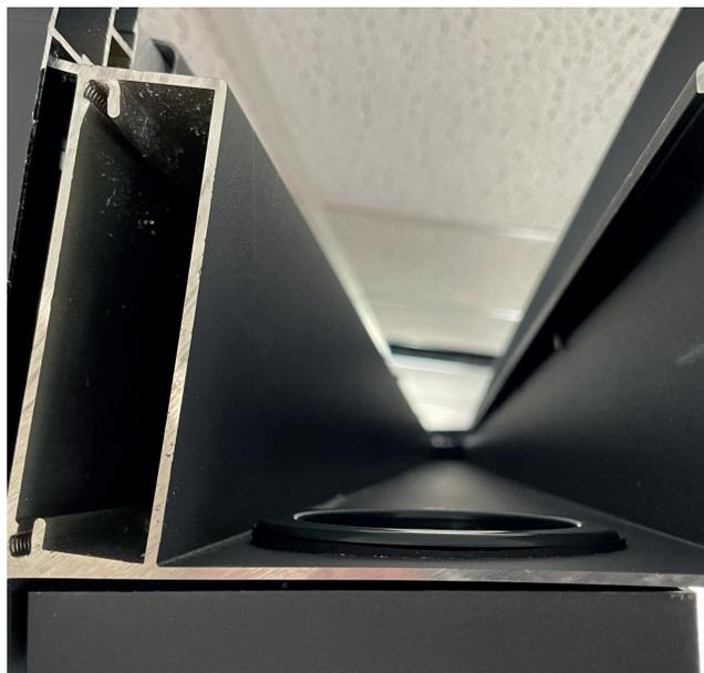
Retirez le pilier de la partie inférieure de la gouttière. Vissez soigneusement la partie inférieure à la sortie. (Attention, évitez d'endommager le filetage en plastique, ne forcez pas sur cette pièce, elle doit être serrée en douceur autant que possible jusqu'à ce qu'elle soit serrée contre la gouttière. Si elle tourne difficilement, dévissez-la et recommencez avec précaution.)
